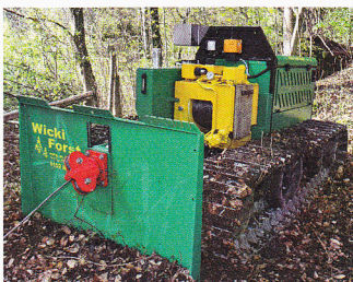
Die Wiki Raupe 50. 6A steht noch bei 6 t Zug stabil.
